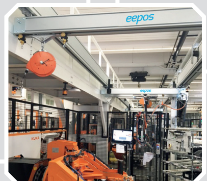
Station 2: Schrauberzelle mit eePOS Kränen
